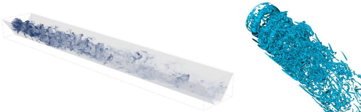
*Figure 1 : mélange d'éthanol dans du CO<sub>2</sub> supercritique dans une puce microfluidique avec prise en compte des frontières immergées (gauche) ; isolement des structures turbulentes à l'aide de l'isosurface du critère Q (droite).*
